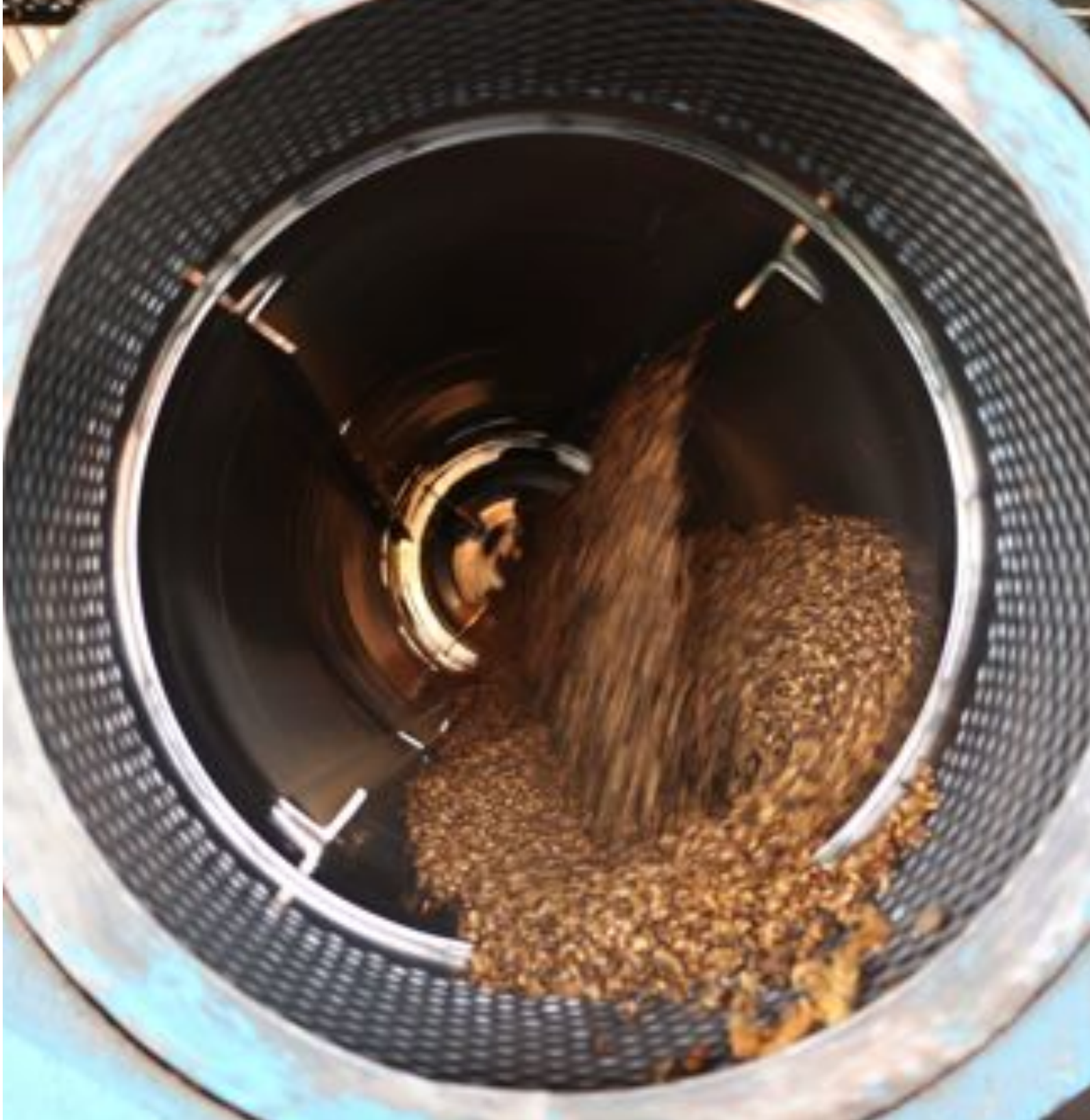
Pembersihan dan pemisahan Inti Sawit- PKS Kintap, Kalimanta Selatan. Palm Kernel cleaning and separation - Palm Oil Mill Kintap, South Kalimantan.
